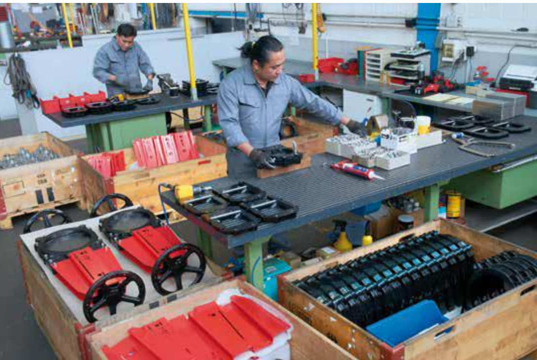
Сборка шибрных ножевых здвижек WEY
